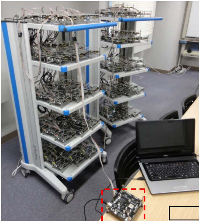
本実証における評価環境 (IC チップ 100 個による並行処理)
