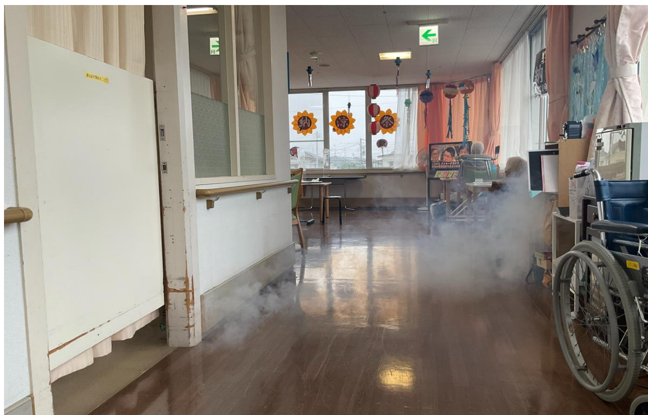
図1 初期感染者が居たと考えられる個室(写真左)から共用エリアへエアロゾルが流出する様子 (特殊スモークによる再現実験)
