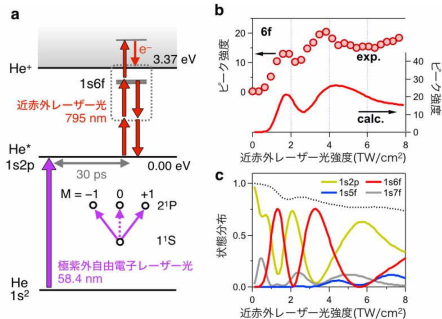
図3：(a)ヘリウム原子のエネルギー準位図と実験スキーム。(b)1s6f 光電子ピークの近赤外レーザー光強度依存性（丸印）および対応する理論計算結果（実線）。(c)理論計算で得られた1s2p および1s5f, 1s6f, 1s7f 準位の状態分布の光強度依存性。
