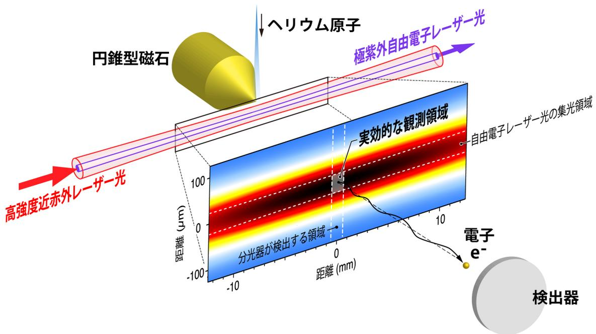
図1：焦点付近における近赤外レーザーパルスの光強度分布。自由電子レーザー光の集光領域に励起ヘリウム原子が生成する。光電子分光器が検出する領域はレーザー進行方向に1ミリメートル程度であるため実効的な観測領域の光強度はほぼ一定となっている。
