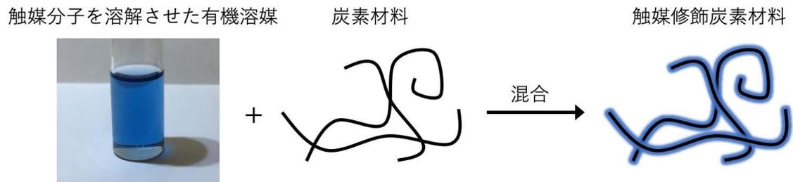
図 2. 触媒修飾炭素の作製法
