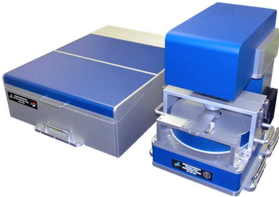
図4 デュアルコム磁気光学効果測定装置のプロトタイプ
