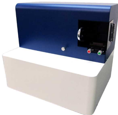
図5 デュアルコム複素屈折率測定装置の試作機（測定装置本体）
