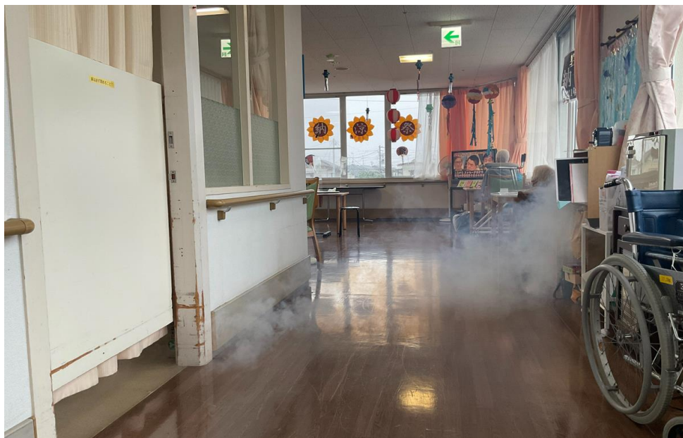
図1 高齢者施設における風下汚染クラスターの再現実験 (陽性者の入居している居室からデイルームに向かってエアロゾルが流れる様子)
