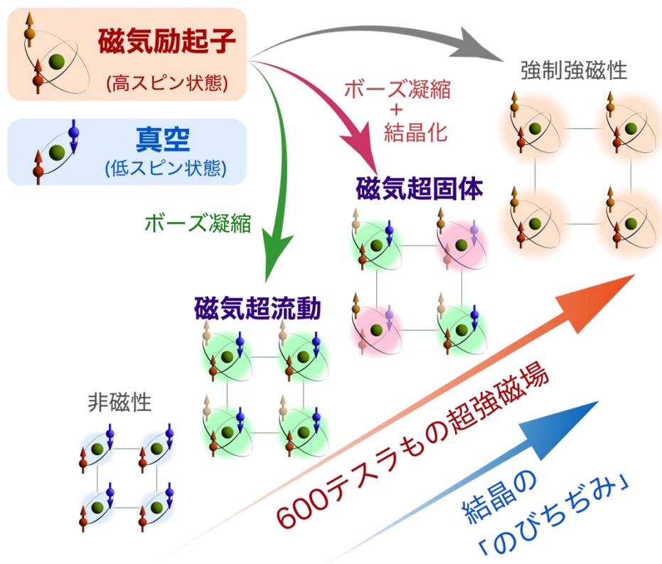
図3 コバルト酸化物に超強磁場を印加することで磁気「超」状態とそれらの間の状態変化が生じる様子の概念図。LaCoO<sub>3</sub>には「真空（低スピン）」と「磁気励起子（高スピン）」の状態があります。磁場をかける前はすべてのコバルトイオンが真空状態です。600 テスラまでの超磁場をかけると変化が起こり、磁気超流動状態や磁気超固体状態が発現します。磁気励起子は結晶格子を押し広げる性質があるので、今回の「のびぢみ」計測によりこれらの変化の兆候を観測しました。最終的にはすべてのコバルト酸化物が完全に磁化した状態になると期待されますが、今回はその観測には至っていません。
