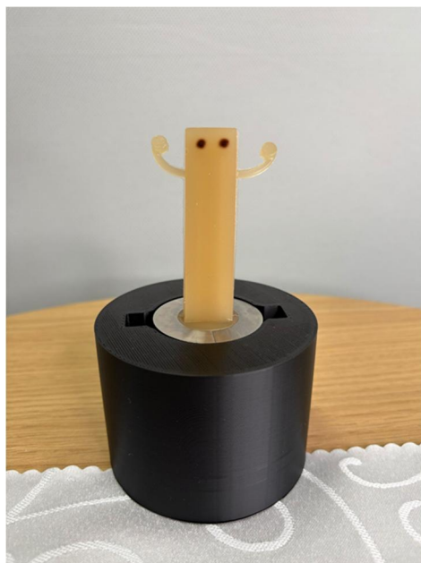
図1 本研究で用いた可食エージェント。可食材料で作られ、音声に同期して左右に揺れる。
