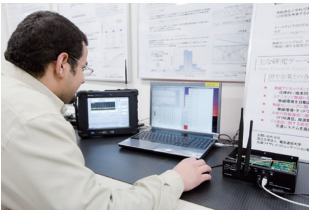
ボードにプログラムを実装してコグニティブ無線機の動作を確認
