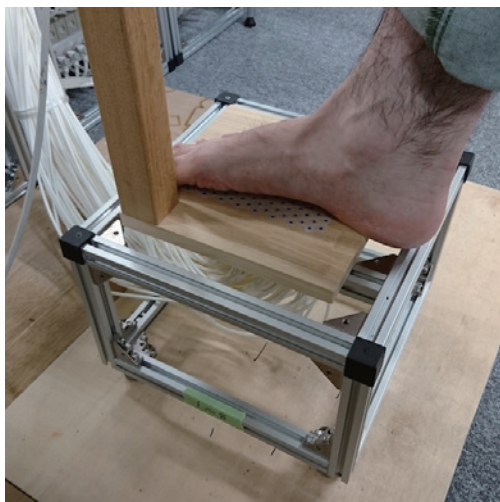
足裏に触力覚を提示する試作装置
