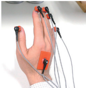
爪にセンサを取り付けた様子
