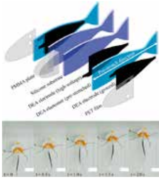
魚ロボットの構成と泳ぎの様子
