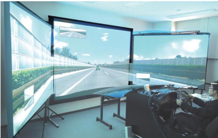
認知工学実験用のドライビングシミュレーター
