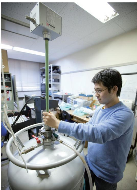
液体ヘリウムデューワーに低温プローブ挿入
