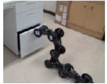
持ち上げた先頭部で軽作業 (例：引き出し開け)
